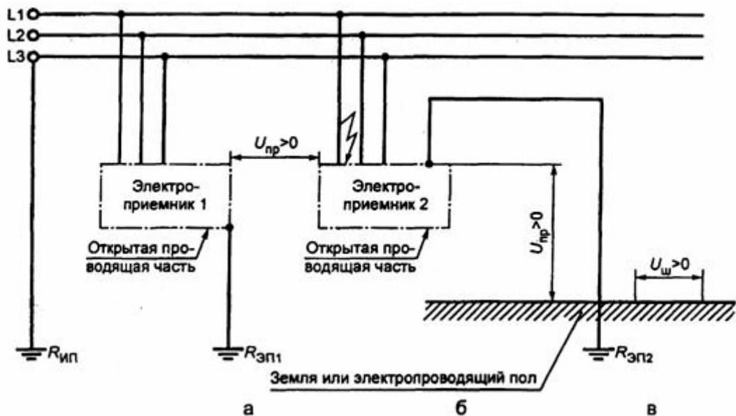
Рисунок В.11 — Сеть ТТ без нулевого рабочего проводника с однофазным замыканием на корпус
