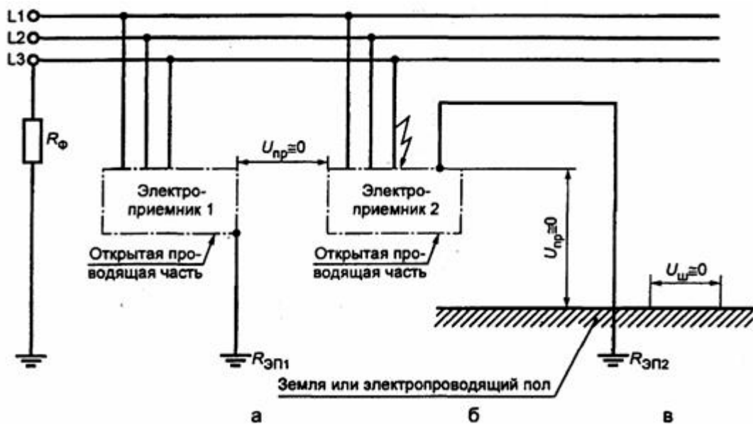
Рисунок В.13 — Сеть IT с заземлением фазы источника питания через сопротивление с однофазным замыканием на корпус
